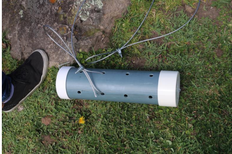
Gráfico 14. Muestreadores pasivos colocados en los cuerpos de agua
