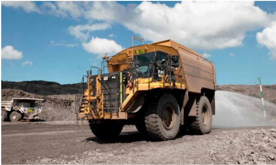
Figura 9. Tanquero utilizado para el riego de las vías Fuente: Cerrejón
