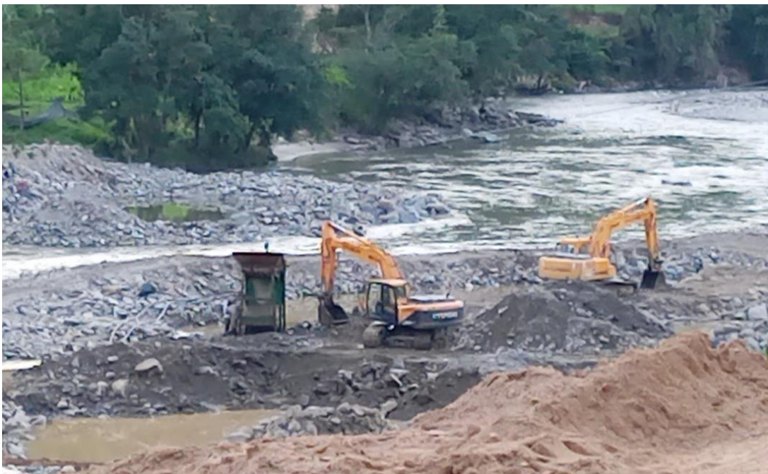
Figura 4. Equipo pesado para realizar la explotación minera de oro aluvial. Fuente y elaboración propias.
