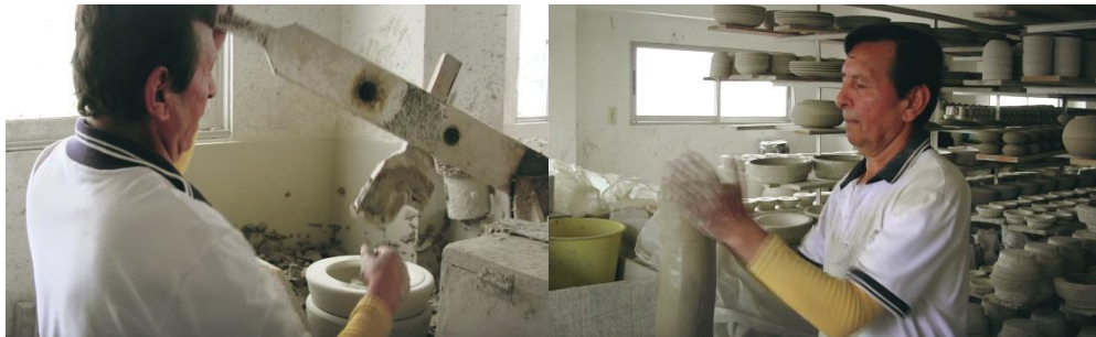
7 Proceso de torneado con molde para la elaboración de vasijas, cerámicas Renacer, Municipio El Carmen de Viboral, Serie "Actos creativos otros" n. 13 y 14, Autoría propia, Archivo personal, 2015
