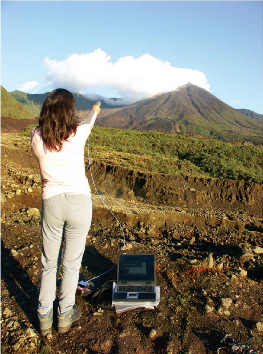
**Figura 16.** Medición de emisiones gaseosas en el volcán Reventador con el *sensor remoto* portátil DOAS (Espectrómetro de Absorción Óptica Diferencial, por sus siglas en inglés). Este instrumento mide a distancia el contenido de gases magmáticos en las emisiones volcánicas y por sus características puede ser rápidamente utilizado en cualquier volcán (foto por D. Andrade).
