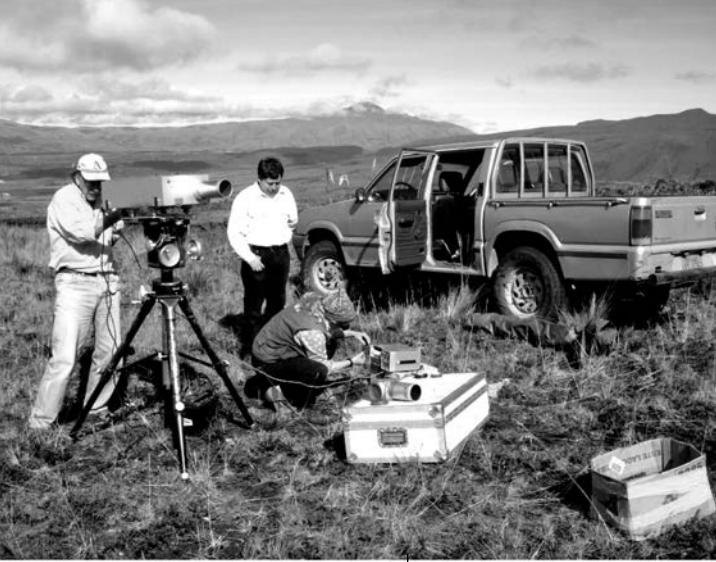
Figura 29. El sensor remoto COSPEC (espectrómetro de correlación, por sus siglas en inglés) mide a distancia el contenido de gases magmáticos en las emisiones volcánicas. Un alto contenido de gases magmáticos (p.e. \text{SO}_2 ) puede significar que un período de actividad volcánica se aproxima. Izquierda: medidas realizadas en el Cotopaxi. Derecha: medidas realizadas en el Tungurahua. (Fotos: P. Mothes y D. Andrade).
