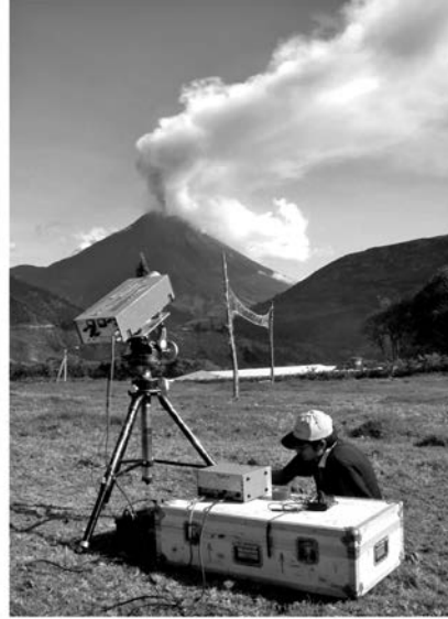
Figura 29. El sensor remoto COSPEC (espectrómetro de correlación, por sus siglas en inglés) mide a distancia el contenido de gases magmáticos en las emisiones volcánicas. Un alto contenido de gases magmáticos (p.e. \text{SO}_2 ) puede significar que un período de actividad volcánica se aproxima. Izquierda: medidas realizadas en el Cotopaxi. Derecha: medidas realizadas en el Tungurahua. (Fotos: P. Mothes y D. Andrade).
