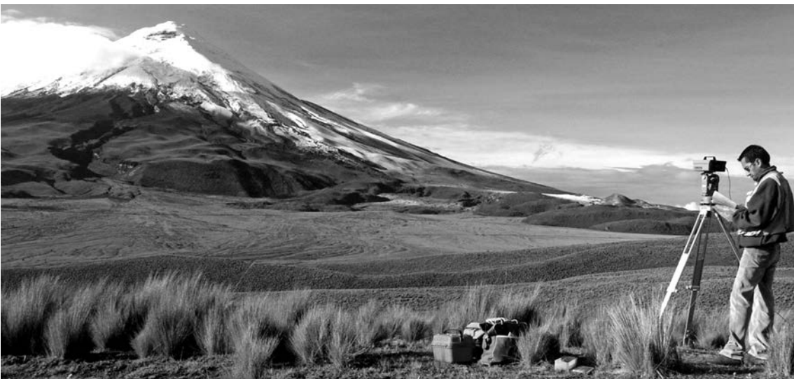
Figura 26. Mediciones de EDM realizadas desde la base BOSQ (ver también Fig. 24). El EDM es un instrumento que mide con gran precisión la distancia entre dos puntos fijos mediante un emisor y un reflector de rayos láser. (Foto: P. Mothes).
