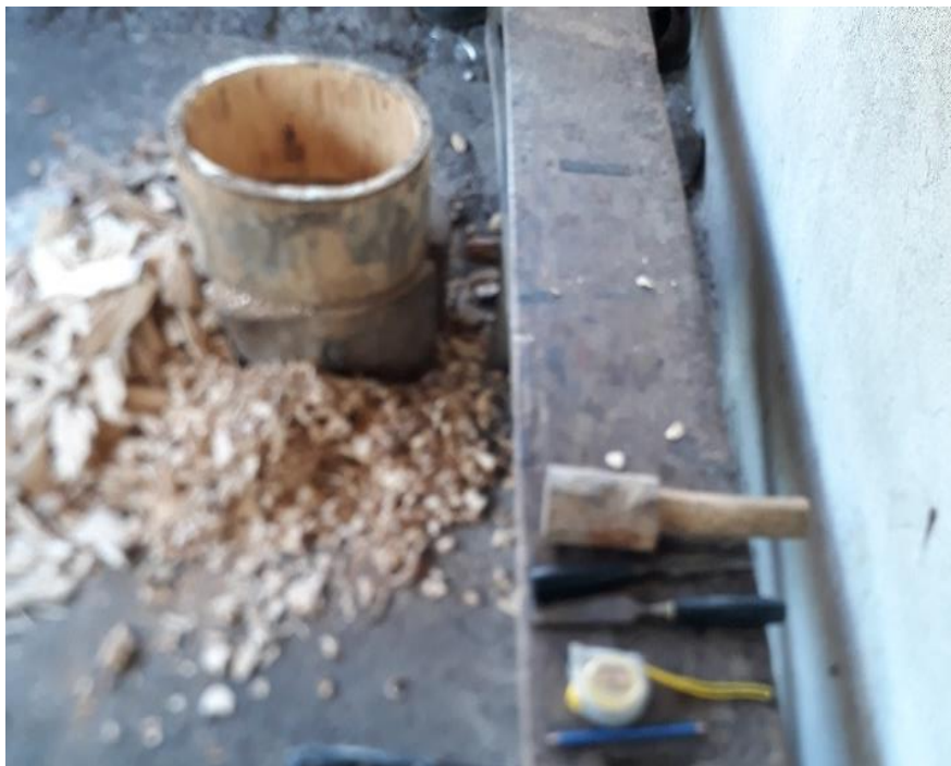
Fotografía 2. Haciendo el cuerpo de la Bomba (Pachaco, combo, cinceles) Fuente y elaboración propias
